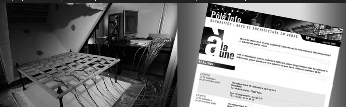
Dispositif de mesure des températures dans le four expérimental du laboratoire LSGS - Maquette du nouveau pôle info
