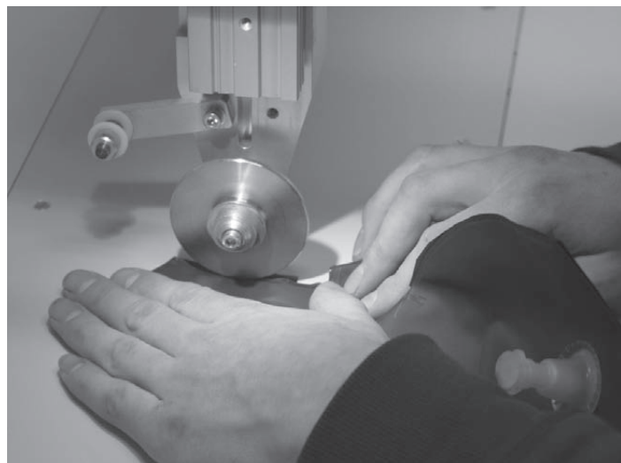
Soudure de plastique pour la réalisation de gonflable
